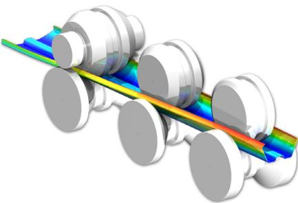
Mit COPRA® FEA RF lassen sich selbst komplexe Walzprofiliervorgänge mit hunderten Stationen sowie vor- und nachgeschalteten Bearbeitungsschritten zuverlässig und schnell berechnen. Die Modellerstellung erfolgt dabei vollautomatisch.
