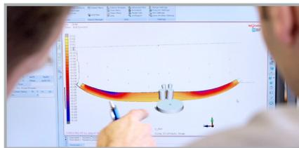
Beim 3D Walzprofilieren vereinen wir unser Know-how, CAE-Tools und Hardware (COPRA® 3D Roll Forming Center) – ideal für eine effiziente Prozessauslegung und die Prototypenfertigung von flexiblen Profilen (z.B. Fahrwerksteile für Kleintransporter).
