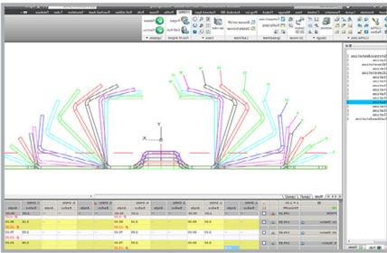
COPRA® RF deckt die gesamte Prozesskette Walzprofilieren ab und hält mit seinen zahlreichen Hilfsfunktionen und Modulen maßgeschneiderte Softwarelösungen für Rohrhersteller wie für Profilerer bereit.
