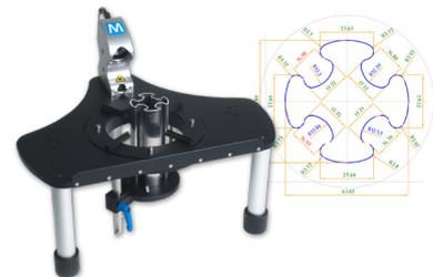
Der COPRA® RollScanner nimmt Rollendaten auf und ermöglicht zusätzlich die Qualitätskontrolle und die Analyse der Walzenform - der erste Schritt zur Optimierung Ihres Werkzeugs.
